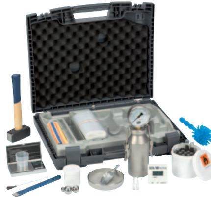
Basé sur le procédé d'ampoules au carbure de calcium, il est destiné à mesurer l'humidité des chapes, dalles en béton et dérivés.
