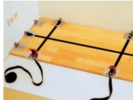
Pour assembler et serrer les lames de parquets traditionnels, stratifiés et des panneaux rainurés.
