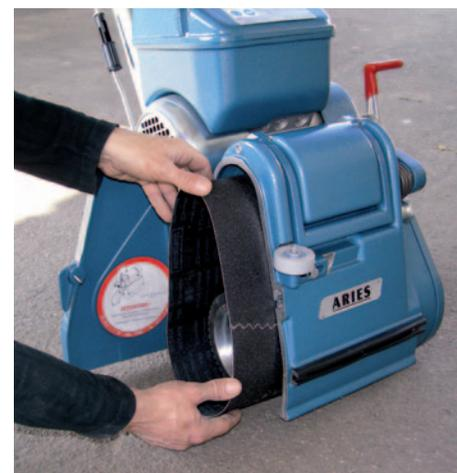
Machine à deux vitesses pour un ponçage de qualité permettant le dégrossissage et la finition.
